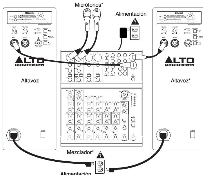
Este diagrama es una sugerencia para la instalación del altavoz con conexiones de audio. Para aparear el altavoz con un dispositivo Bluetooth, consulte la sección APAREAMIENTO CON BLUETOOTH Y ENLACE más abajo.
