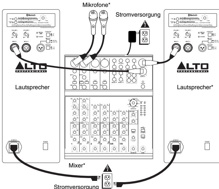
Diese Übersicht dient als Beispiel, wie Sie Lautsprecher und Audioanschlüsse einrichten können. Um den Lautsprecher mit einem Bluetooth™-Gerät zu koppeln, lesen Sie bitte den Abschnitt KOPPELN & VERBINDELN ÜBER BLUETOOTH weiter unten.
