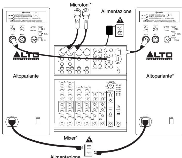
Questo schema suggerisce come configurare l'altoparlante con collegamenti audio. Per accoppiare l'altoparlante con un dispositivo Bluetooth™, si veda il paragrafo ACCOPPIAMENTO E COLLEGAMENTO BLUETOOTH qui di seguito.
