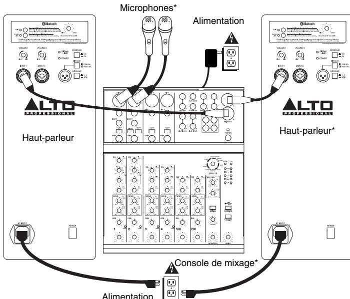
Ce schéma de connexion représente un exemple de connexion audio. Pour jumeler le haut-parleur avec votre appareil Bluetooth, consultez la section JUMELAGE ET MISE EN PARALLÈLE ci-dessous.
