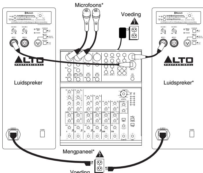
Dit schema is een suggestie voor de installatie van de luidspreker met audioaansluitingen. Raadpleeg het hoofdstuk KOPPELEN EN VERBINDEN MET BLUETOOTH hieronder om de luidspreker te koppelen aan een Bluetooth™-apparaat.
