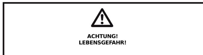
Trennen Sie vor dem Austausch der Sicherung das Gerät unbedingt vom Netz.
