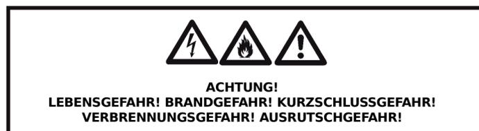
Sorgen Sie immer für genügend Durchlüftung. Unzureichende Lüftung kann zur Kondensation der Nebelflüssigkeit und somit zu rutschigen Flächen führen, die Unfälle verursachen können. Halten Sie einen Mindestabstand von ca. 25 cm rund um die Nebelmaschine ein.
