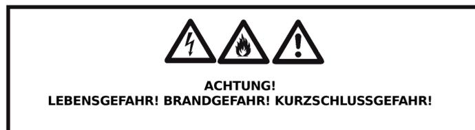
Das Produkt muss regelmäßig von Staub, anderen Ablagerungen und Verschmutzungen gereinigt werden, weil ansonsten die Schutzisolierung reduziert werden könnte, was zu tödlichen Stromschlägen führen kann!
