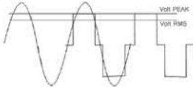
Als je de uitgangsspanning wilt meten heb je een TRUE (echte) VOLT METER nodig. Als je de spanning gaat meten met een 'standaard' voltmeter zul je een spanning meten welke ±20 a 30 volts lager is dan de werkelijke uitgangsspanning.
