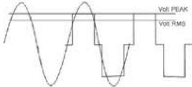
Zur Messung der Ausgangsspannung benötigen Sie ein echtes (TRUE) RMS Spannungsmessgerät. Wenn Sie die Ausgangsspannung mit einem ,normalen Gerät messen, liegt das Ergebnis 20-30V unter der tatsächlichen Ausgangsspannung.
