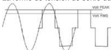
Si vous voulez mesurer la tension de sortie, vous avez besoin d'un VOLTMETRE TRUE RMS. Si vous mesurez la tension avec un voltmètre standard, vous obtiendrez une mesure de +/-20 à 30V inférieure à la tension de sortie réelle.
