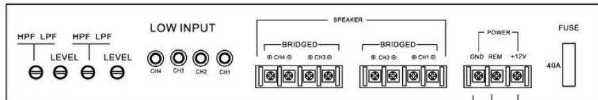
Raccorder à la broche à distance de mise sous tension de l'unité source
