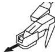
**Hinweis:** Wenn die Auto-Stop-Funktion aktiviert ist, wird der Plattenspieler automatisch am Ende der Musik zu stoppen. Wenn Auto-Stop-Funktion ausgeschaltet ist, wird der Plattenspieler nicht automatisch gestoppt und drehen die Plattenteller durch.
