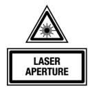
**CAUTION - CLASS 3B** LASER LIGHT WHEN OPEN AVOID EXPOSURE TO THE BEAM
