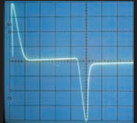
Fig. 3 Oscilloscopbild, förlustkurva kabel med brett liv
