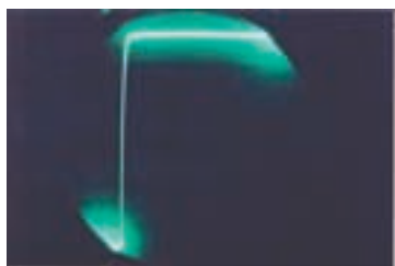
Bild 1 visar referensen, en special GR-terminerad 50 ohms last som uppträder som en närmast ren resistans vid alla frekvenser upp till över 26 GHz (hög HF).
