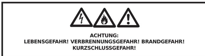
Das Produkt darf nur im Trockenen betrieben und gelagert werden! Spritzwasser, Regen, Feuchtigkeit, Nebel können die Schutzisolierung reduzieren, was zu tödlichen Stromschlägen führen kann! Der Grenzwert für die relative Luftfeuchtigkeit liegt bei 50% bei 45 Grad Celsius. Zu einer Nebelmaschine muss ein Mindestabstand von 1,5 m eingehalten werden; die Nebelsättigung im Raum darf eine Sichtweite von 10 m nicht unterschreiten.
