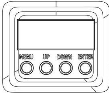
Het bedieningspaneel biedt verschillende mogelijkheden zoals: eenvoudige invoeren van het startadres, voorgeprogrammeerde programma selecteren of een reset. Het hoofdmenu wordt geopend door op de **Mode**-toets, blader door het submenu door **Up** of **Down**-toets.
