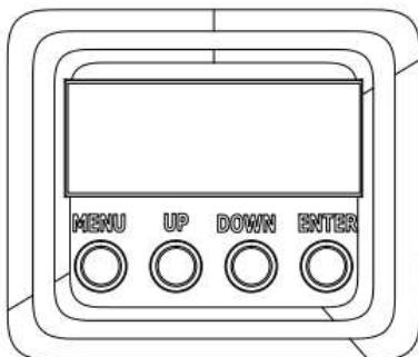
Le panneau de commande vous permet d'effectuer différents réglages : réglage de l'adresse de démarrage, gestion d'un programme pré-programmé, lancer un Reset. Le menu principal est accessible en appuyant sur la touche **Mode**, vous pouvez naviguer dans le sous-menu avec la touche **Up** ou **Down**.
