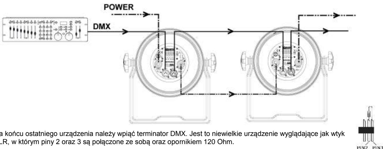
Na końcu ostatniego urządzenia należy wpiąć terminator DMX. Jest to niewielkie urządzenie wyglądające jak wtyk XLR, w którym piny 2 oraz 3 są połączone ze sobą oraz opornikiem 120 Ohm.
