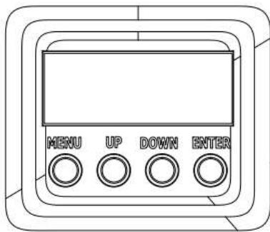
Die Konsole bietet verschiedene Funktionen wie: einfache Eingabe der Startadresse, wählen Sie Preset-Programm oder ein Reset. Das Hauptmenü wird durch Drücken der **Mode**-Taste aufgerufen, blättern Sie durch die Untermenüs durch **Up** oder **Down**-Taste.
