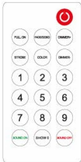
**COLOR**- Appuyez sur la touche pour activer le mode Dimmer. Utilisez les touches 1-9 pour sélectionner la couleur voulue. Réglez l'intensité de sortie en utilisant les touches “DIMMER+” et “DIMMER-”..
